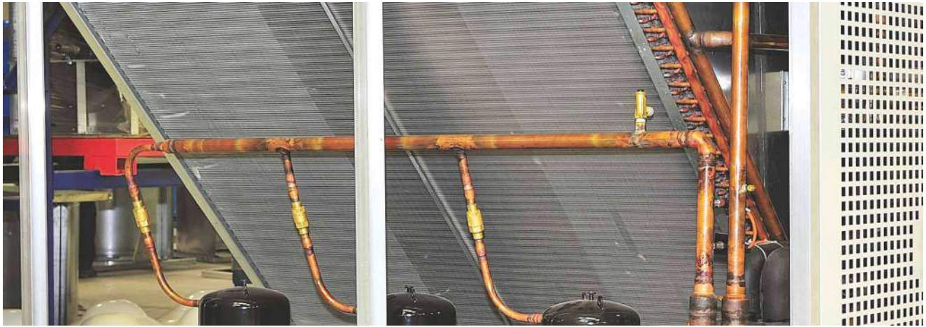
Konvansiyonel tip bakır boru/alüminyum kanatlı kondanser sistemi/ Conventional type copper tubes/aluminum fins condenser system
