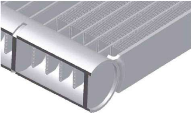
Mikrokanallı alüminyum boru / alüminyum kanat kondanser sistem - Microchannel aluminum tube/aluminum fin condenser system
